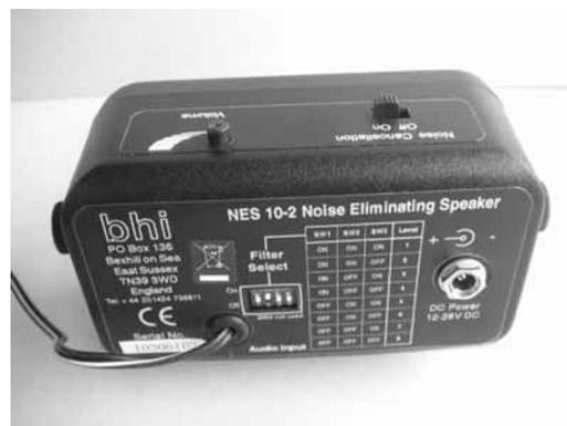
Hersteller des NES-10-2 ist die englische Firma bhi (<http://www.bhi-ltd.co.uk>). Die Elektronik des NES-10-2 ist in ein kompaktes Lautsprechergehäuse (11 x 6,5 x 5,5 cm) eingebaut. Auch hier wird ein Netzgerät (10-20 V/500 mA) benötigt (nicht mitgeliefert). Kopfhöreranschluss und Schalter sind an den Seiten des Gehäuses untergebracht. Das Anschlusskabel zum RX ist fest mit dem NES verbunden und hat einen 3,5 mm Mono-
